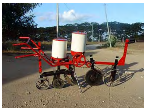
Photo semoir brésilien pour le semis direct en culture attelée
