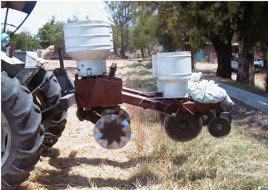
Photo 6 : Semoir spécifique pour semis direct de maïs et sorgho
