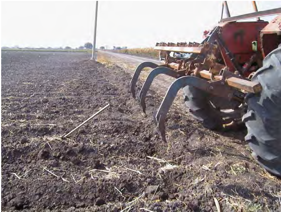
Photo 10: La cultivadora, outils à dents pour retracer les raies d'irrigation et effectuer les désherbages mécaniques
